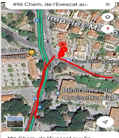
Coulage sur 22m \_\_Déchargement à la brouette attention au attentes \_\_Le camion devra rentrer en arrière dans le portail pour ne pas gêner la circulation \_\_Prévoir une brouette pour lavage toupie \_\_BÉTON S4 conseillé \_\_Confirmer cubage formule et cadence avec client \_\_Attention chantier chemin de l'evescat au Sablette préciser au chauffeur
